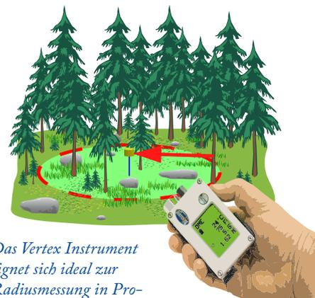
*Das Vertex Instrument eignet sich ideal zur Radiusmessung in Probeflächen, es vereinfacht die Arbeit und liefert ein extrem genaues Ergebnis. Mit der integrierten BAF-Funktion können Sie den Mindestdurchmesser von Bäumen ermitteln, den diese haben müssen, um in der Fläche gezählt werden zu können. Die BAF-Funktion ermöglicht Ihnen eine akkurate Punktverprobung an Orten mit dichtem Unterholz, wo herkömmliche Prismen versagen.*
