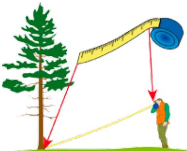
*Die für die Höhenmessung erforderlichen Grundliniendistanzen werden von der Basis des Baumes zum Auge des Benutzers gemessen. Seien Sie bei der Messung so präzise wie möglich und heben Sie die Entfernung per Tastendruck ein, um akkurate Höhenmesswerte zu erhalten!*
