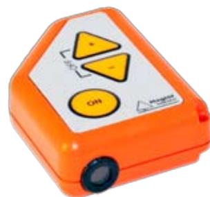
Der Haglöf EC II ist ein einfach einzusetzendes Feldinstrument, das präzise Messergebnisse der Neigung und Höhen von Objekten, üblicherweise Bäume, liefert. Höhen werden aus jeder bekannten Distanz gemessen. Mit der hochpräzisen elektronischen Darstellung der Ergebnisse wird der EC II Ihnen lange gute Dienste leisten und ihnen ganz ohne Kalibrierung oder Wartung immer genaue Messwerte liefern.
