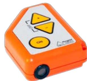
Le Haglöf EC II est un instrument de terrain facile à utiliser qui offre des résultats de mesure précis sur l'inclinaison et les hauteurs d'objets, généralement des arbres. Les hauteurs sont mesurées depuis toute distance connue. Avec la présentation électronique des résultats de précision, l'EC II vous servira longtemps, donnant toujours des mesures précises sans calibrage ni entretien.
